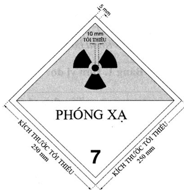
Hình 5. Nhãn cảnh báo phóng xạ: nửa trên nền màu vàng, nửa dưới nền màu trắng, dấu hiệu cảnh báo bức xạ màu đen, chữ màu đen, kích thước mỗi chiều tối thiểu 250 (mm).
